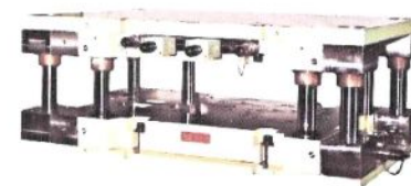
■油圧ユニットとFBダイセット：FB Dieset with hydraulic source
