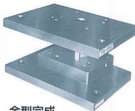
金型完成 Completed die
